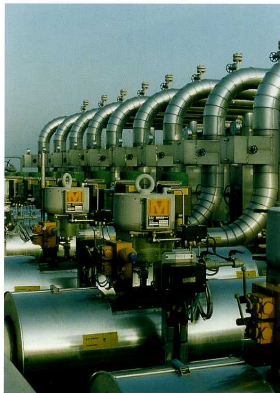
Отсечные клапаны на шлейфах установки добычи газа, Нидерланды (фото любезно предоставлено компанией NAM)
