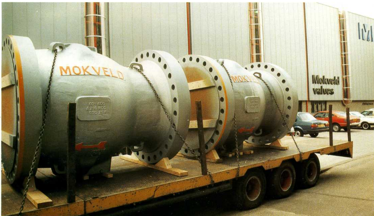
Бесшумные обратные клапаны 60" ANSI 600 фунтов по пути к монтажу на газообрабатывающей установке в Аласке.
