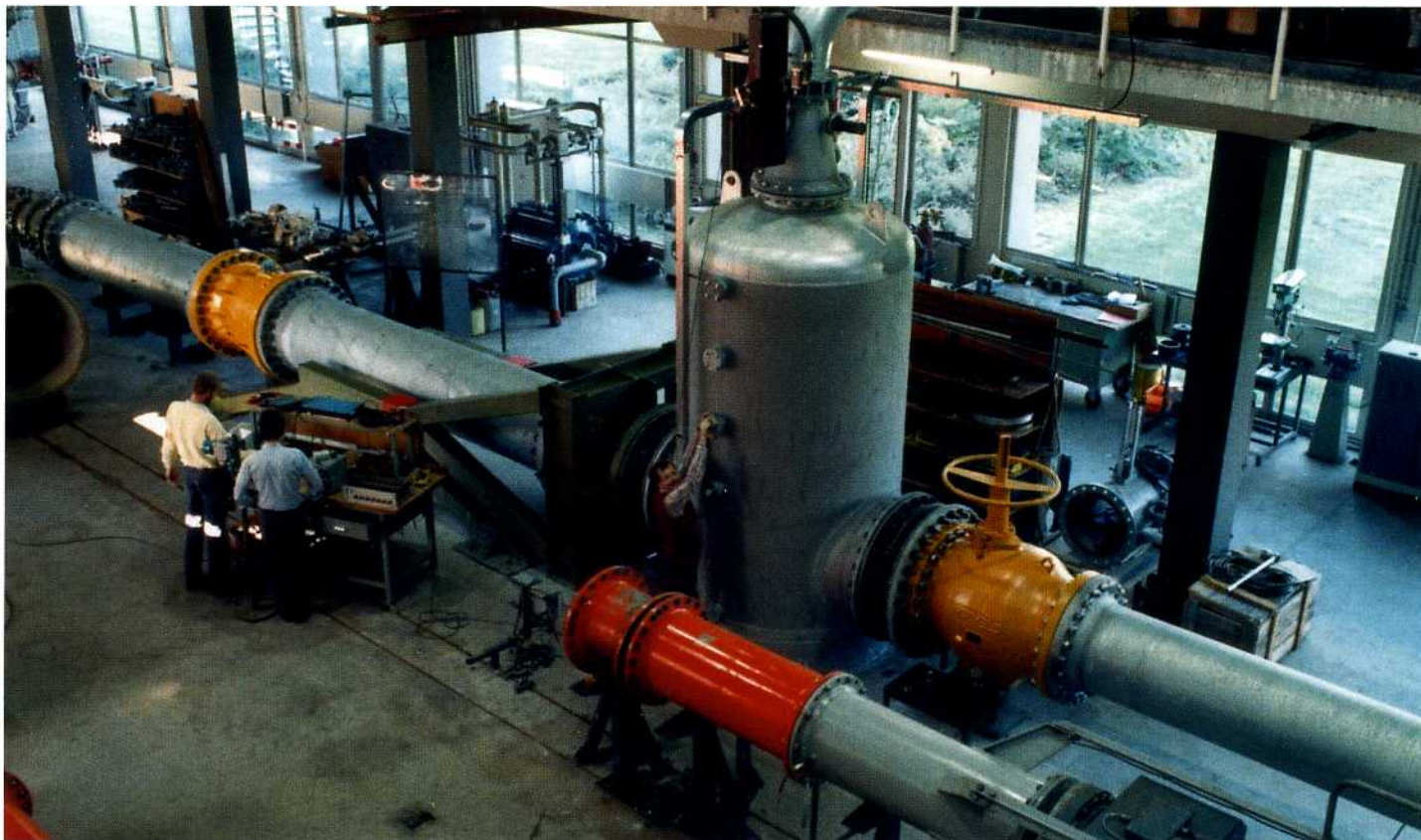
Испытания регулирующего клапана
